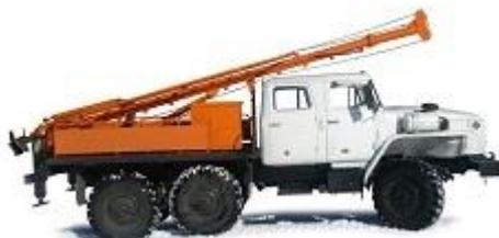
В народе БКМ получила название «ямобур», за то, что отверстия в земле, которые получаются при использовании этой машины, очень напоминают ямки: неглубокие, большого диаметра.
