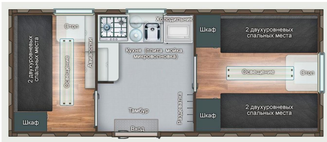
Жилой модуль, в котором могут проживать 5-6 человек в двух отдельных комнатах. Комнаты также комплектуются двух- или одноуровневыми спальными местами, оснащенными вещевыми рундуками; шкафами для одежды и столиками общего пользования.
