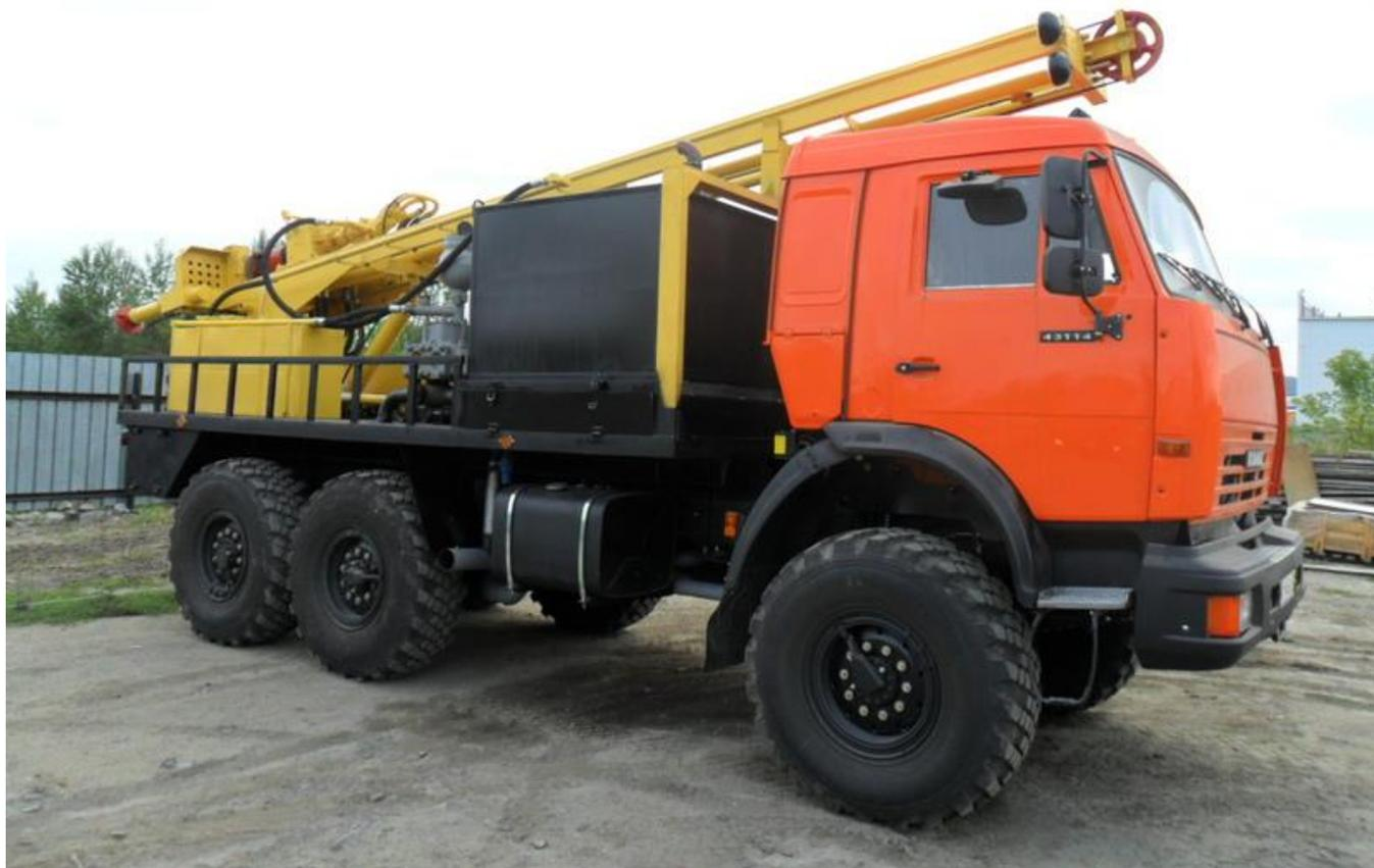
Самоходные буровые установки типа УРБ-2А2 и их модификации применяются при решении широкого спектра задач, связанных с бурением скважин различного назначения. УРБ-2А2 активно используются в геологоразведке, при проведении инженерно-геологических изысканий, для бурения структурно-поисковых, гидрогеологических, сейсмических и разведочных скважин на различные полезные ископаемые.
